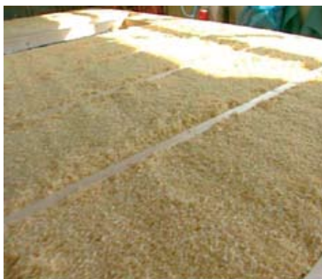
Рис. 3. Щиты заводского изготовления с деревянным каркасом, утеплителем из стружки и облицовкой деревянным сайдингом изготавливаются на заводе
