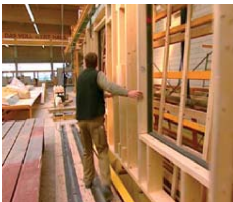
Рис. 3. Щиты заводского изготовления с деревянным каркасом, утеплителем из стружки и облицовкой деревянным сайдингом изготавливаются на заводе
