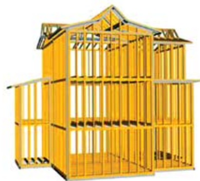
Рис. 2. Каркасные дома имеют деревянную обрешетку из стоек. Каркас обшивается плитами из фанеры, ОСБ-панелей, цементно-стружечными плитами (ЦСП) или другими большеразмерными элементами с заполнением внутреннего пространства ограждающих конструкций эффективным утеплителем
