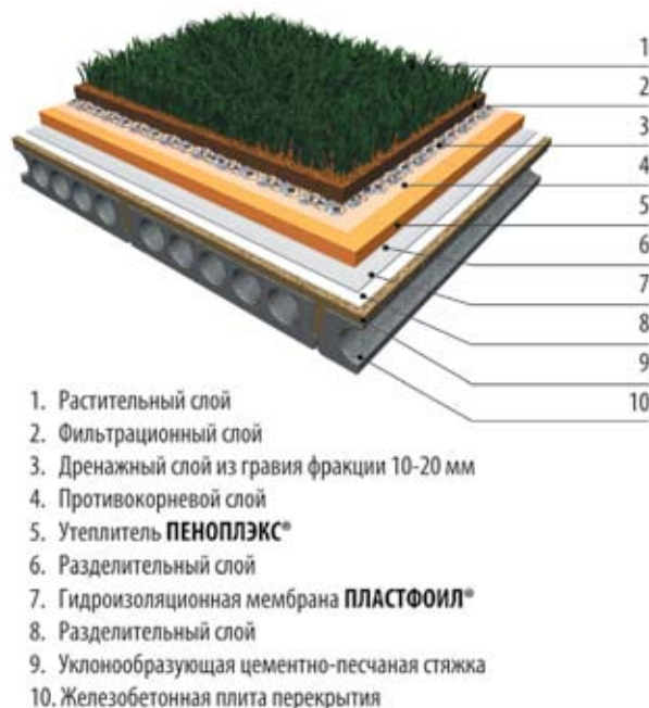
Рис. 3. Инверсионная кровля с материалом ПЛАСТФОИЛ®
