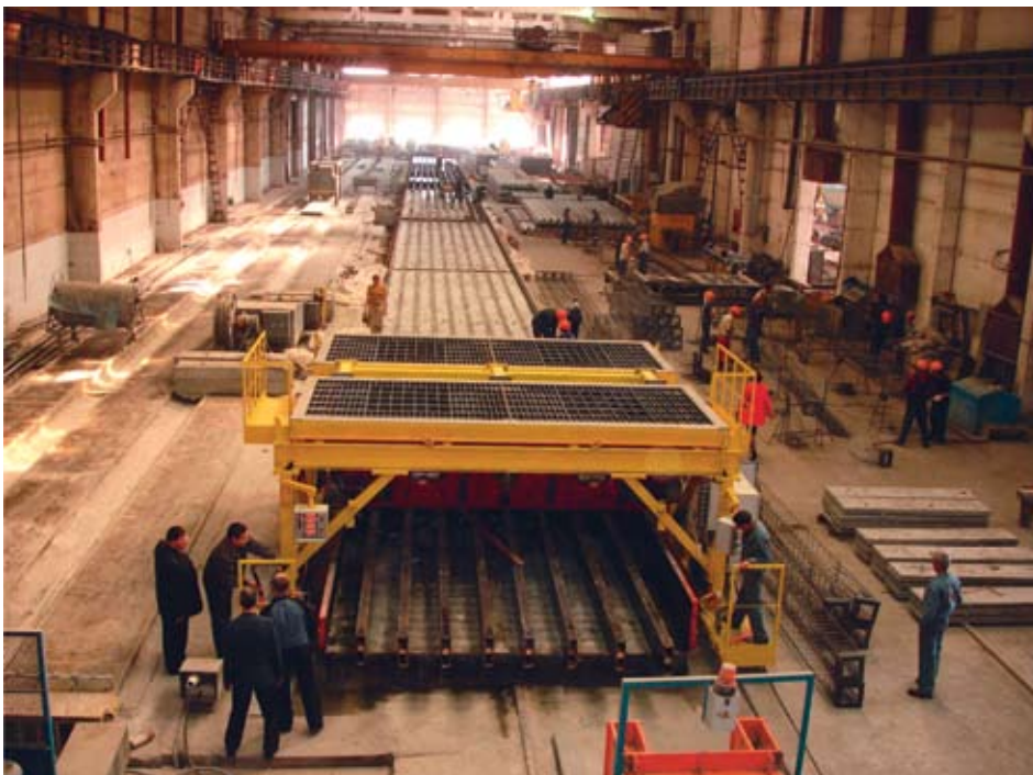
Универсальный вибробетонораздатчик с поворотным бункером на испытании по выпуску свай на универсальном стенде l=108 м, ОАО «Монолитстрой», ЗАО «Рекон», 2010 г.
