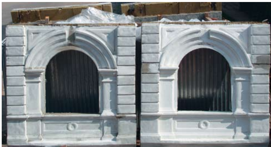
Ограждающие конструкции наружных стен высокой архитектурной выразительности и заводской готовности, выпускаемые на универсальном стенде, г. Чебоксары, 2008 г.
