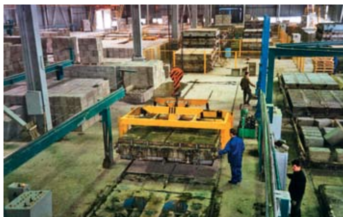
Рис. 4. Формовочный цех завода ЗАО «Юникон-ЗСК»
