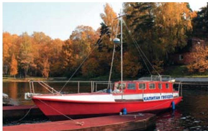
Рис. 4. Катер с водонепроницаемым корпусом из малоклинкерного наноцемента, толщина стенок — 12 мм
