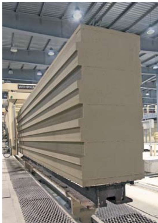
Профилирование армированных плит на высокоточной линии резки Wehrhahn
