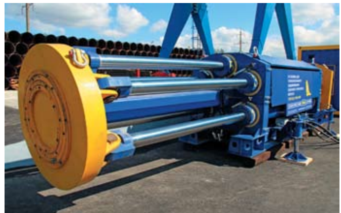
Установка «Бобр» для горизонтального продавливания трубошпунта
