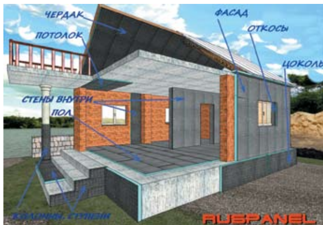
Монтаж на стены снаружи и внутри
