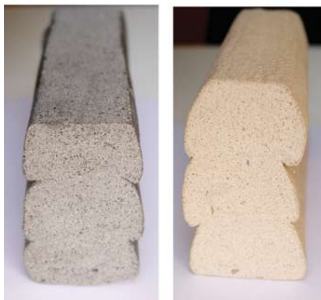
Рис. 9. Элемент стены и примеры слоев геополимерного бетона, напечатанные с помощью 3D-принтера
