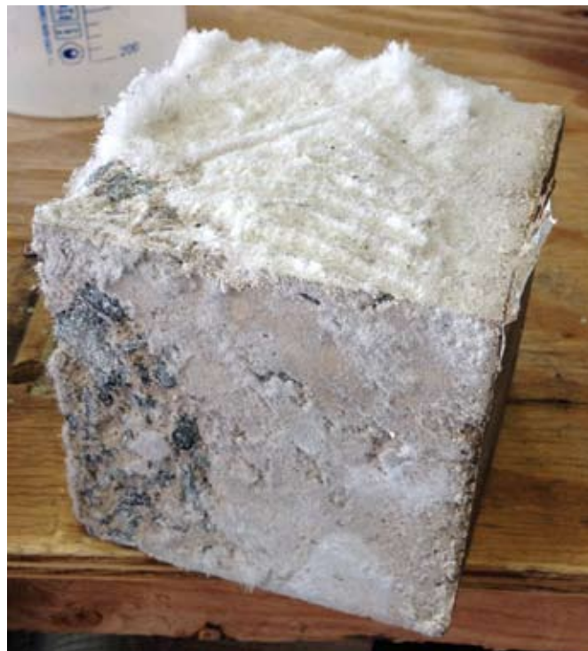
Рис. 1. Высолообразование на поверхности шлакощелочного бетона
