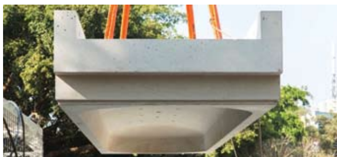
Рис. 12. Изготовление плит перекрытия из геополимерного бетона на заводе ЖБИ, Австралия (Wagners)
