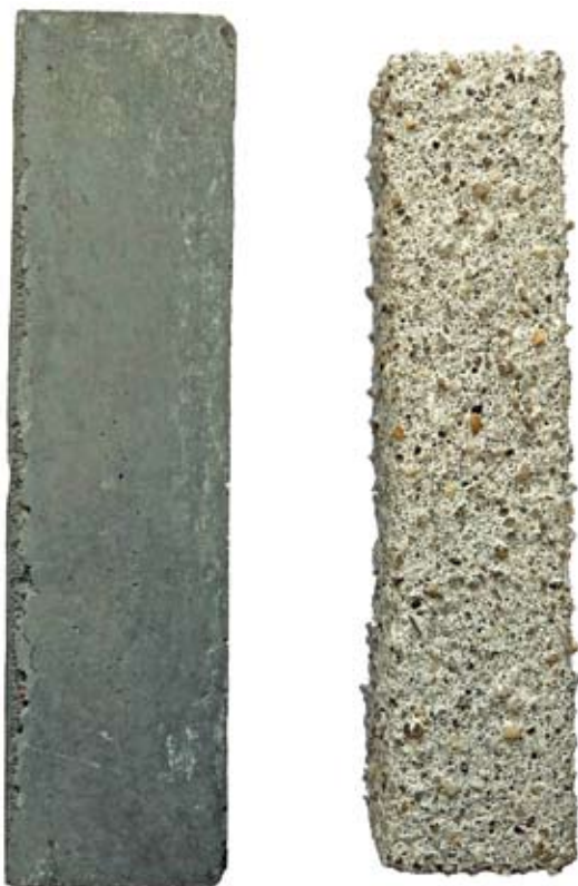
Рис. 14. Образцы геополимерного бетона (слева) и бетона на базе портландцемента (справа) после погружения в 10%-ный раствор серной кислоты на 28 суток (испытания лаборатории «Геобетон», 2017)
